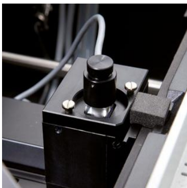
Тримач кювети, термостатований елементом Пельтьє, гарантує точність встановлення температури. Температура вимірюється безпосередньо в кюветі
