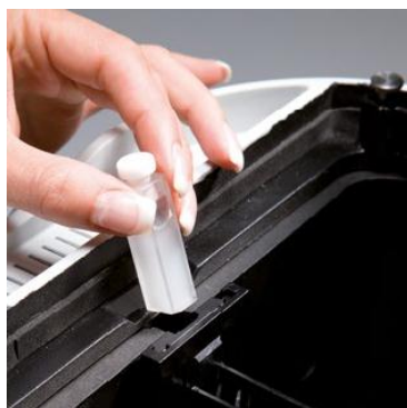
Спеціальна позиція для розміщення мутних зразків з сильним розсіюванням
