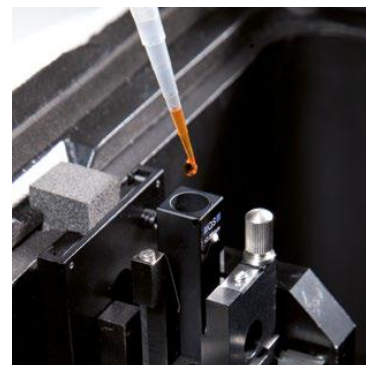
Знімний тримач ультрамікрокювет для точного кількісного аналізування надто малої кількості проб
