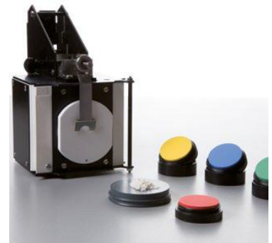
Приставка для визначення коефіцієнта дифузійного відбиття з інтегрованою сферою
